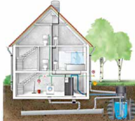
Yağmur Suyu ile Kombine Edilmiş Gri Su Sistemi
